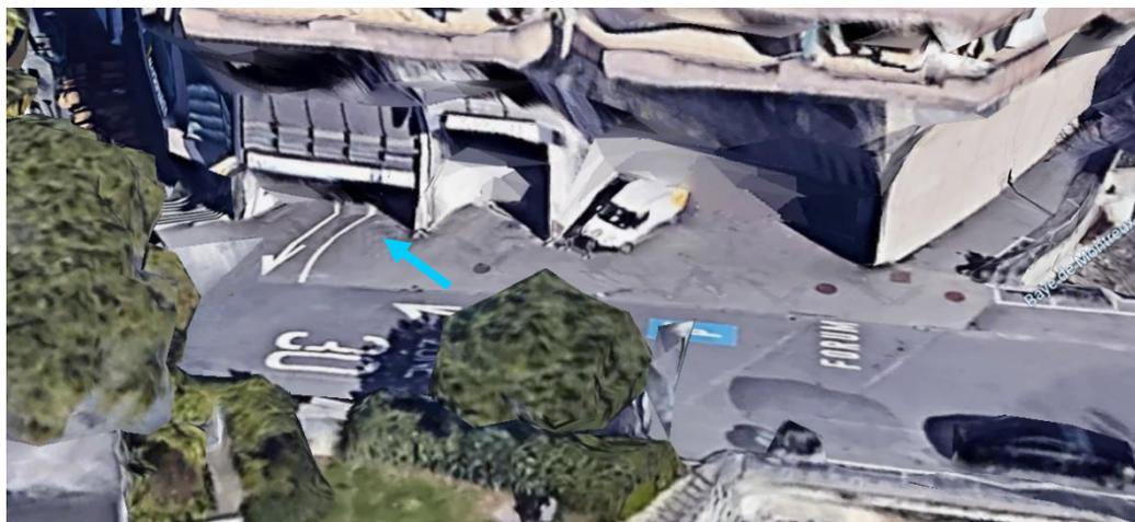
Fig. 5: [entrée de parking souterrain](#) située dans la zone de danger bleu, près de l'embouchure de la Baye de Montreux dans le lac Léman (rue du Théâtre). La flèche bleue indique la ligne d'écoulement possible de l'eau. Capture d'écran sur Google Earth.
